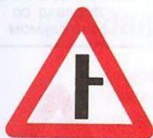
Примыкание второстепенной дороги
