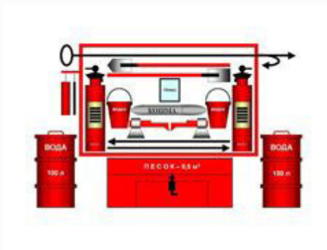
Рисунок 3.2. Оборудование пожарного щита.
