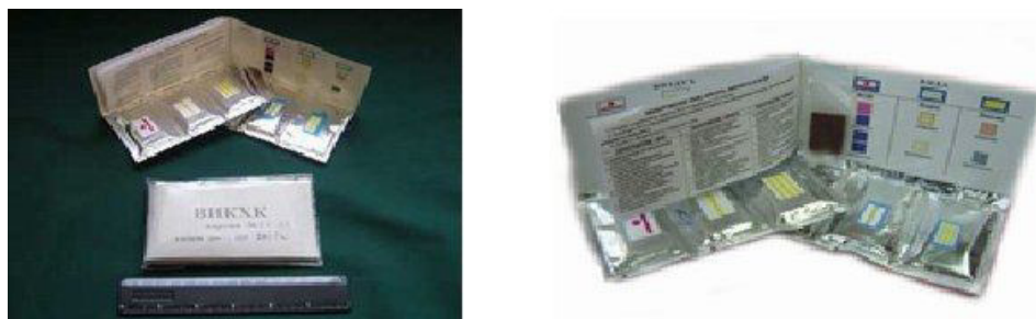
Рисунок 2.12. Войсковой индивидуальный комплект химического контроля (ВИКХК)
