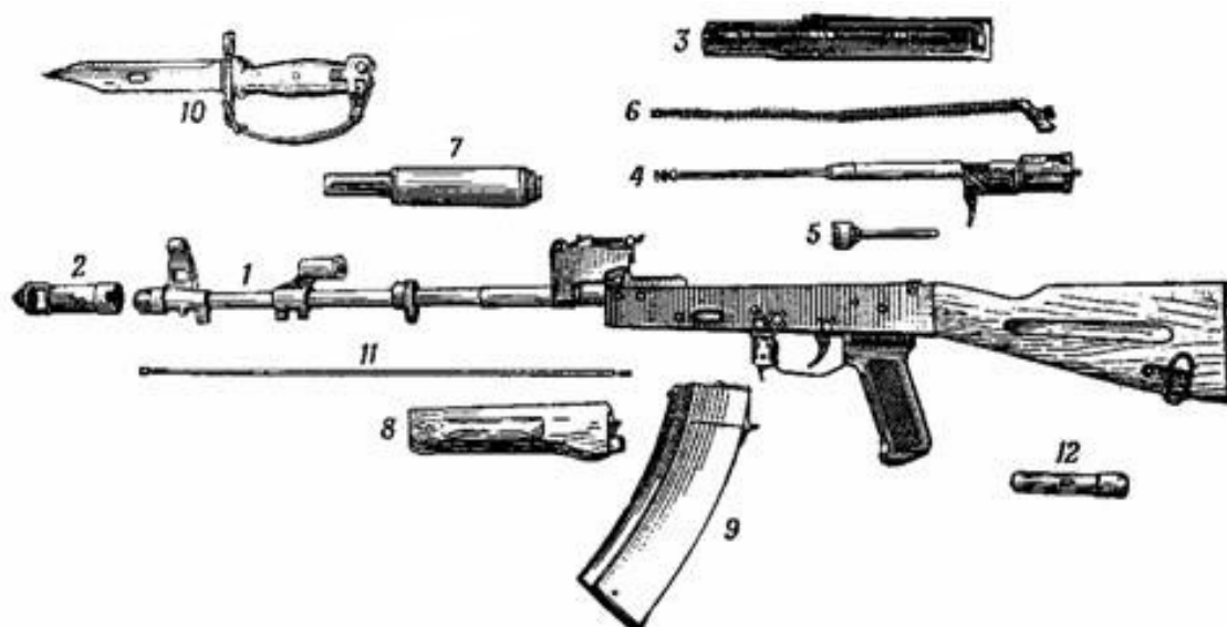
Рисунок 21.1. Основные части и механизмы автомата
