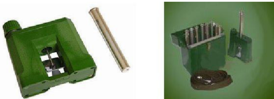
Рисунок 2.9. Комплект войсковых измерителей дозы ИД-1
