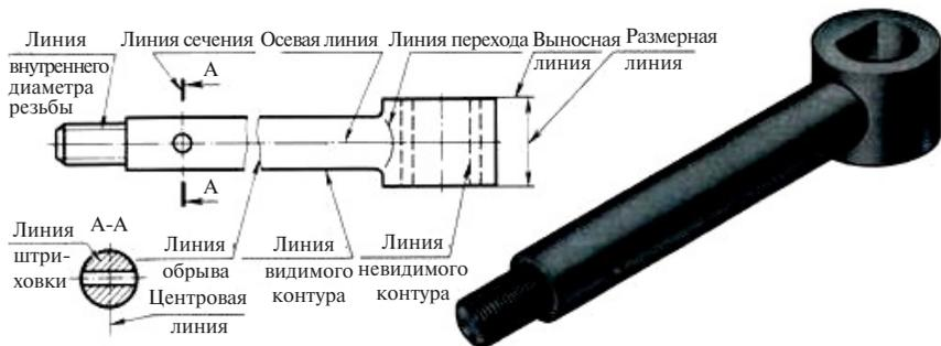
Рис. 3. Пример использования линий на чертеже
