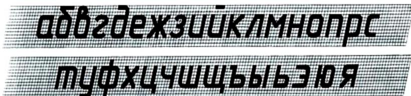
Рис. 4. Чертежный шрифт типа Б с наклоном 75°
