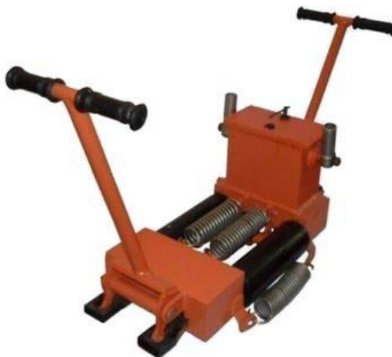
Рис.3. Схема гидравлического разгонщика РН-01
