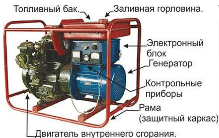
Рис.1. Переносная электрическая станция типа АБ.
