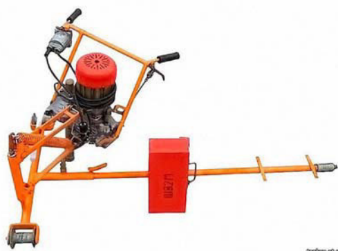
Рис.3. Схема шуруповёрта ШВ-2М
