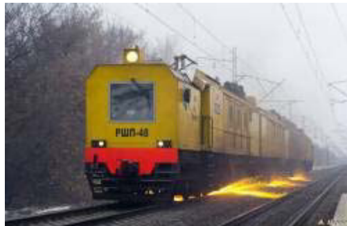
Рис.1. Рельсошлифовальный поезд РШП-48
