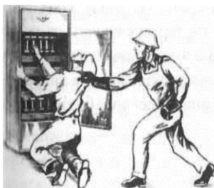
Рисунок 1- Освобождение от действия тока в электроустановках до 1000 В. Отбрасывание провода сухой доской. Спасатель в диэлектрических ботах
